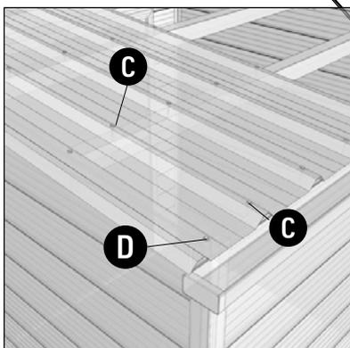
Die Sechskantschrauben werden wie dargestellt C und D durch die Dachpaneele in den Dachbalken geschraubt.
