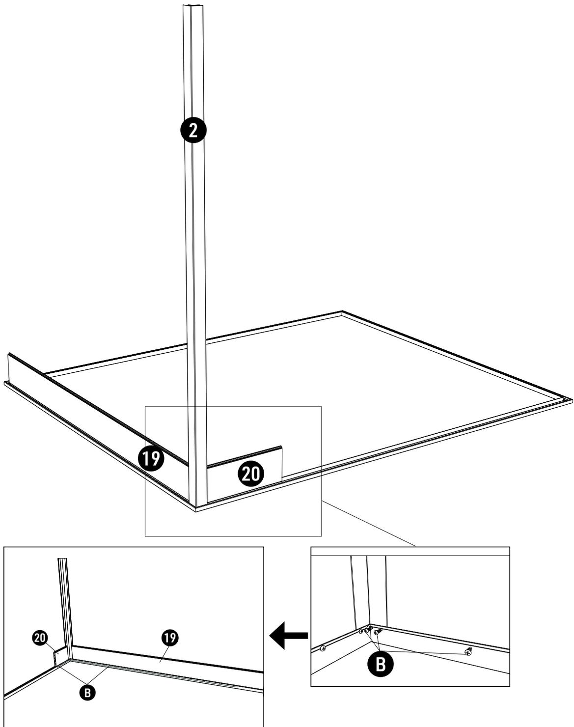
Setzen Sie die WPC Paneele zunächst in die Nut des Pfostens ein.
