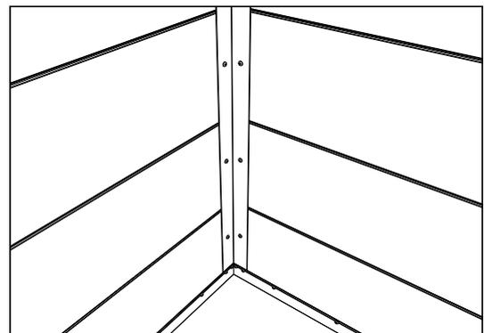
Nach der Montage von vier Reihen der WPC Wandpaneele müssen die Verschraubungen an den Pfosten mit den Rundkopf Kreuzschlitzschrauben erfolgen.
