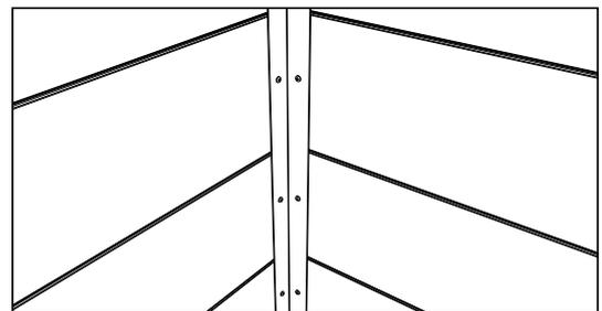
Nach der restlichen Montage der WPC Wandpaneele müssen die Verschraubungen an den Pfosten mit den Rundkopf Kreuzschlitzschrauben erfolgen.
