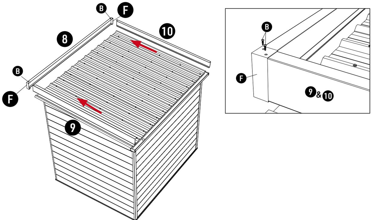
Befestigen Sie die den Verbinder an beiden Seiten des 45° U-förmigen Schlitzes, setzen Sie dann den 45° U-förmigen Schlitz in die Halterung ein, befestigen Sie ihn mit Schrauben und hängen Sie ihn an das Dach.
