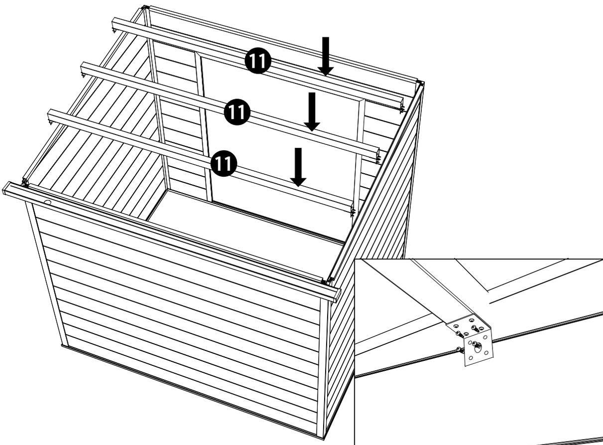
Der quadratische Dachbalken wird mit Rundkopf-Kreuzschlitzschrauben an der Wandplatte befestigt.
