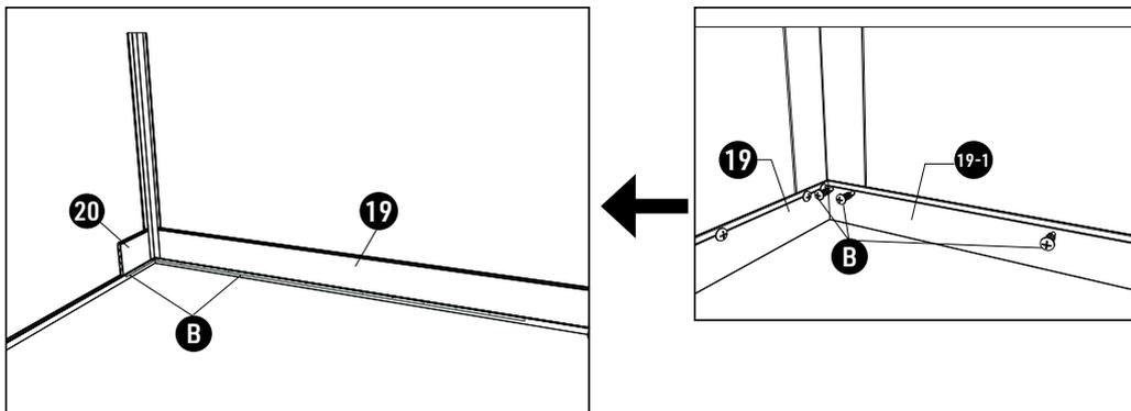
Die vier Seiten der WPC Paneele werden mit Rundkopf-Kreuzschlitzschrauben an den Pfosten verschraubt.
