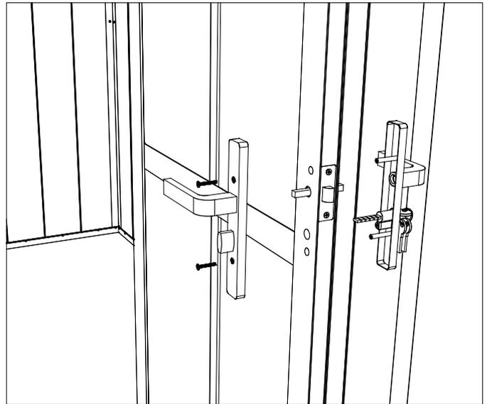
Der Griff wurde für den Transport senkrecht befestigt. Lösen Sie die Schraube und montieren Sie den Türgriff waagrecht.
