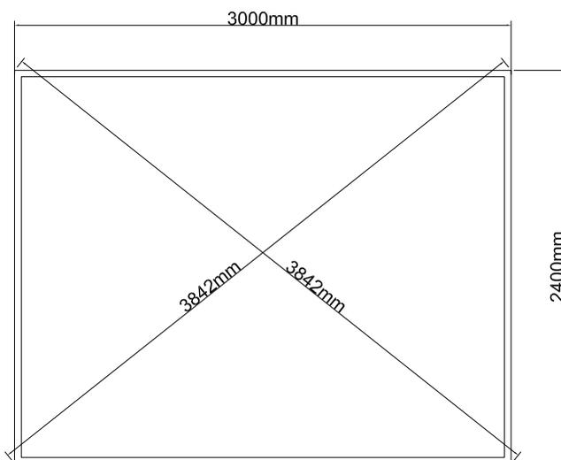
Zeichnen Sie den Installationsbereich mit Kreide ein. Prüfen Sie ob die Bodenplatte in waage liegt bevor Sie mit der Montage beginnen. Das Fundament ist entscheidend für die Sicherheit und Haltbarkeit Ihres Gartenhauses.
